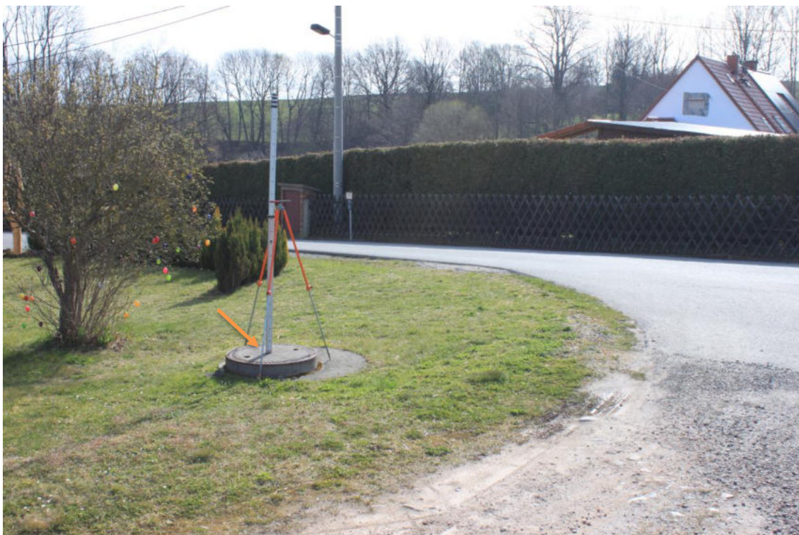
Bild 4: Höhenbezugspunkt (Schachtdeckel: 0,00 m örtl. Höhe)
