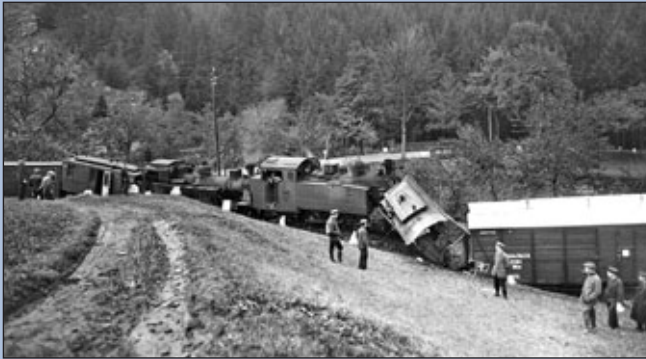
MT-N 21.10.1922: "Am Donnerstag vormittag gegen 8 Uhr stießen zwischen den Stationen Schüllerermühle und Bärenhecke-Johnsbach der aus Richtung Heidenau kommende Personenzug 2894 mit dem aus entgegengesetzter Richtung kommenden Güterzug 10191 infolge falschen Abfahrtsignales zusammen. Eine Lokomotive und mehrere Wagen sind entgleist. Reisende wurden nicht, vom Zugbegleitpersonal sechs, vom Bahnpostpersonal ein Mann leicht verletzt. Aerztliche Hilfe war sofort zur Stelle. Der Sachschaden ist erheblich. Die Betriebsstörung war nachm. nach 5 Uhr behoben. [Bild: Deutsches Uhrenmuseum Glashütte]"
